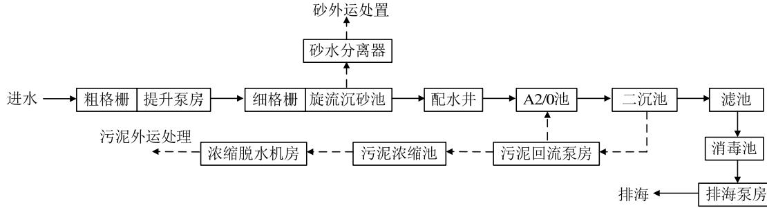
图 2-3 三期工程工艺流程图
