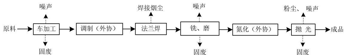
图 5-1 项目生产工艺流程及产污环节图
