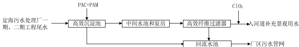
图 2-4 定海再生水厂处理工艺流程图
