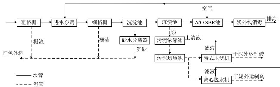
图 2-1 一期工程工艺流程图
